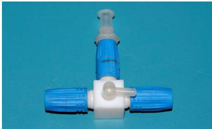
适用于湿法上样。进样时需先停泵，将三通阀上的旋钮指向入液口，使用针式注射器将液体注入，将三通阀上的旋钮指向进样端口，开泵，样品就会随着流动相注入层析柱内。
