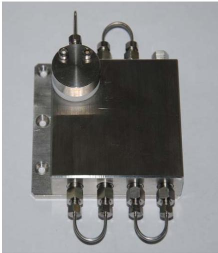
静态混合器是一种没有运动的高效混合设备,通过固定在管内的混合单元内件,使二股或多股流体产生切割、剪切、旋转和重新混合,达到流体之间良好分散和充分混合的目的。
