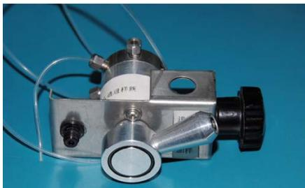
适用于湿法进样。进样前无需停泵，使用针式注射器打入样品，将阀上旋钮转至 load 状态即可。
