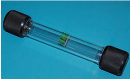
适用于干法上样。当被分离的物质难溶于最初洗脱剂时，可选用一种对其溶解度大而沸点低的溶剂，将样品溶于尽可能少的该溶剂中，将溶液加入吸附剂中或将吸附剂加入溶液中，拌匀，挥干溶剂，研磨使之成为松散均匀的粉末，装填于上样柱内。
