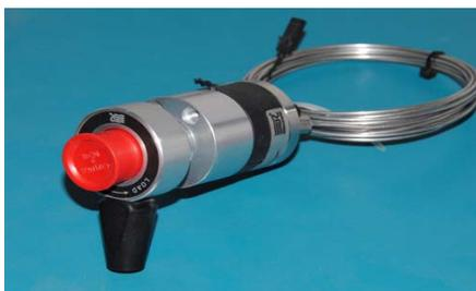
适用于湿法进样。进样前无需停泵，使用针式注射器进样，转动进样阀即可上样。
