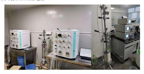
用于离子交换填料, 疏水填料等, 用于填料筛选和工艺开发及中试项目。
