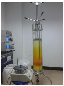
使用分子筛填料要求是填料装填高度大于 75cm, 层析柱柱效要求高, 上样量比较低, 只有填料体积的 1%; 目前多肽中应用相对较少。
