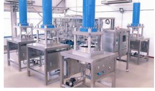
C18 中高压层析系统和动态轴向压缩柱产品,用于客户的工业放大。
