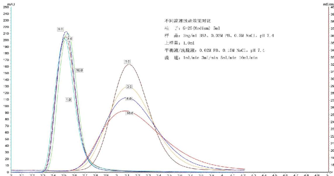
备注：由案例三可以看出流速的变化（在介质可耐受的流速范围内）对目标样本的浓度、回收率、稀释倍数均无影响，仅对脱盐率有轻微的影响。
